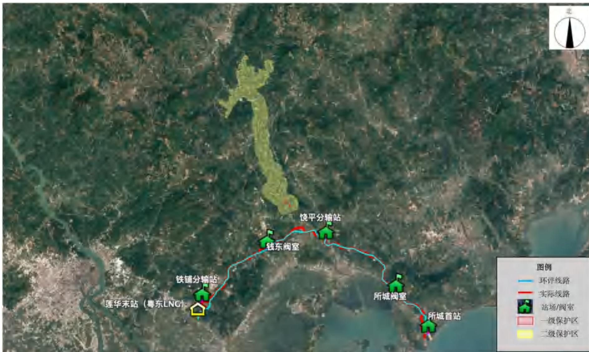
图 1.5-2 本项目外输管道与饮用水源地保护区位置关系图
