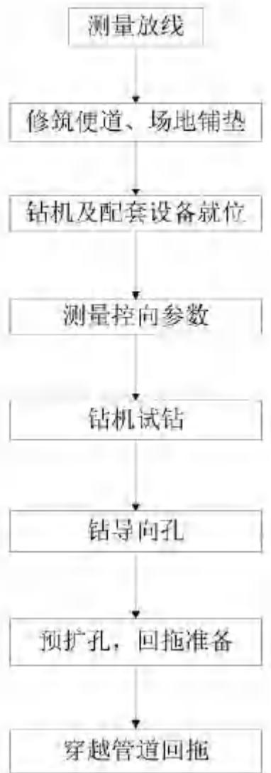
图 2.4-3 水平定向钻施工工艺流程与产污环节图
