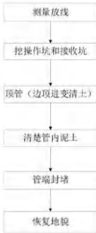
图 2.4-4 顶管施工工艺流程与产污环节图
